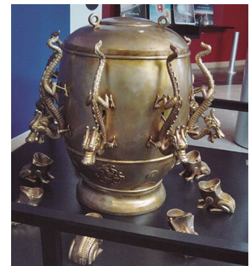
Sismoscopio antecesor del sismógrafo
